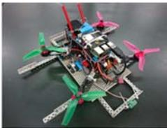
機体の自己位置把握のために、赤外線距離センサーを使用し、目標に設定した高度を維持する制御と壁からの距離を一定に保つ制御の 2 種類で実験を行なった。
